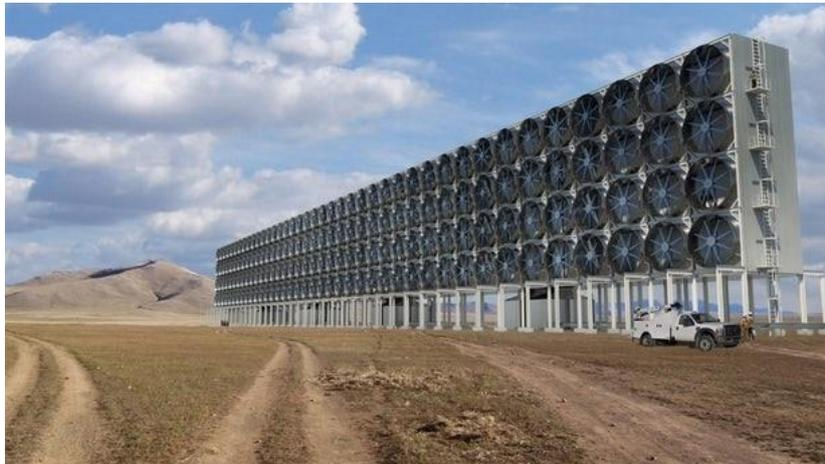
*Figura 41: configurazione del dispositivo di cattura della CO<sub>2</sub> dall'aria con disposizione in batterie*
