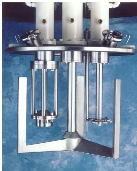
*Figura 9: Triple Shaft Mixers: un albero con girante rotore-statore (a sinistra), uno con palette ad ancora (in centro) e un albero con girante High-shear. Ogni albero è azionato e movimentato indipendentemente dagli altri.*
